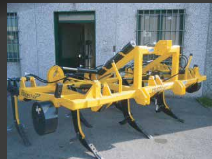
RIPUNTATORE A 7 5+2 RIPIEGHEVOLE IDRAULICAMENTE MOD. PESANTE
