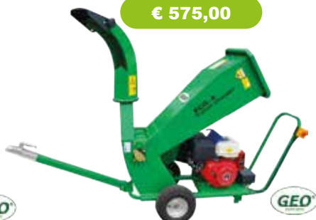
BIOTRITURATORE GEO CON MOTORE 15 CV AVVIAMENTO ELETTRICO
