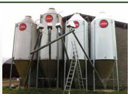
SILOS IN VETRORESINA
