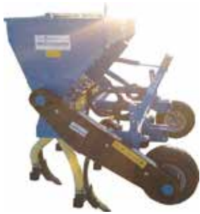
INTERRATORE DI CONCIME
